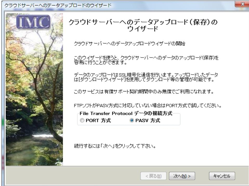
FTP の接続方式は、通常は[PASV 方式]を選択して下さい。FTP クライアントソフト、又は、ルーターが[PASV 方式]に対応していない等が原因で、正常に処理ができない場合には、[PORT]方式を選択して下さい。[PORT]方式を選択された場合は、[2600]番ポートを使用して通信を行いますので、ファイアウォールで[2600]番ポートを遮断しないように設定して下さい。
