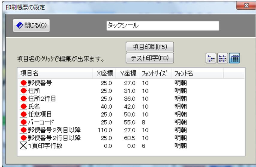
印刷帳票に出力する場合の出力位置の微調整を行います。「項目印刷」ボタンは、設定された帳票の座標等を一覧形式(A4用紙)で出力します。
